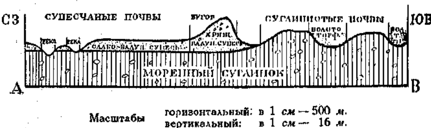
Рис. 110. Схематический профиль геологического строения местности.
