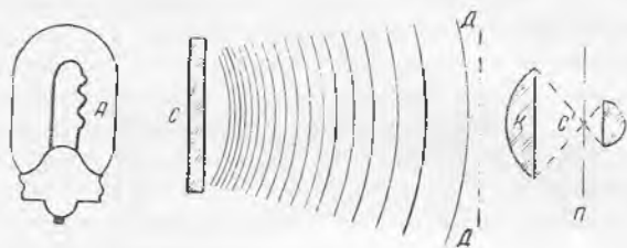
Рис. 21. Способ освещения II: C — матовое стекло, служащее источником света. Остальные обозначения, как на рис. 20
