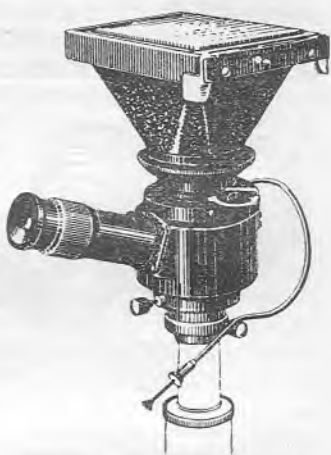
Рис. 45. Универсальная фотонасадка МФН-1
