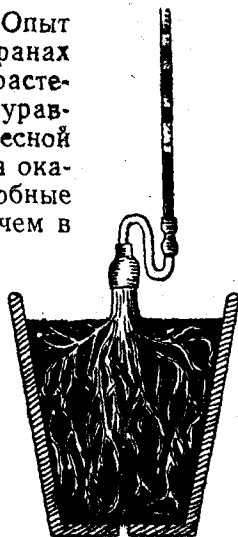
Прибор для измерения корневого давления. К «пеньку» срезанного растения при помощи резиновой трубки подсоединяется манометр.
