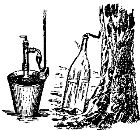
Рис. 56. Аппарат для измерения корневого давления (слева) и плач березы весной (справа)
